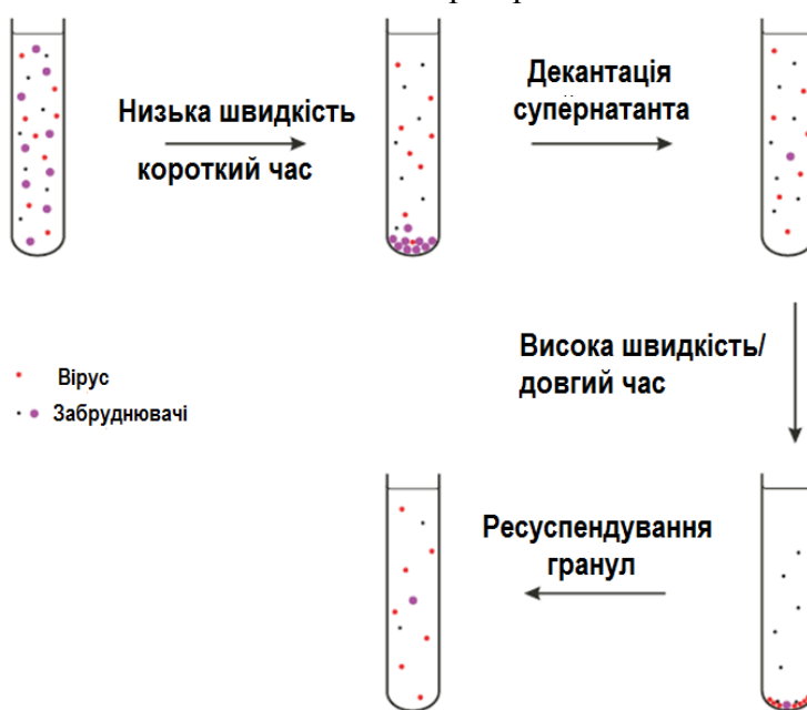
Мал. 13.4. Часткове очищення віріонів диференціальним центрифугуванням
