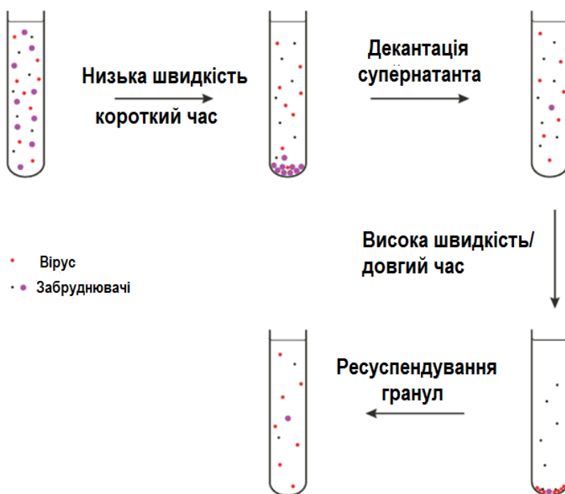
Мал. 12.8. Часткове очищення віріонів диференціальним центрифугуванням (за J. Carter, Vol. Saunders, 2013).
